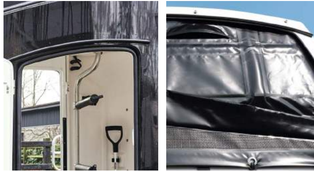
Bescherming tegen de regen dankzij de regenlijst boven de deuren en aan de achterkant.
