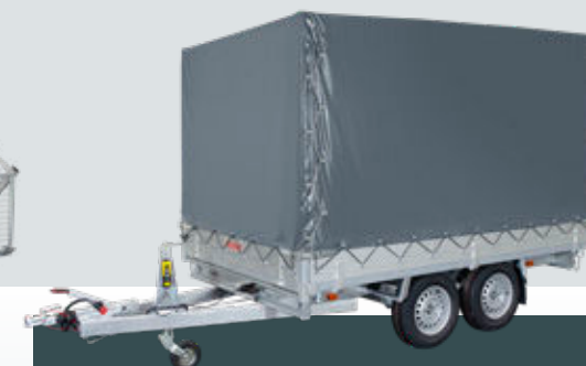
Een KSX kipper met huif. Binnenhoogte 150 of 180 cm. Huif is incl. duurzaam zeildoek, stalen huifframe, aluminium huifplanken, bindhaken en elastiek koord.
