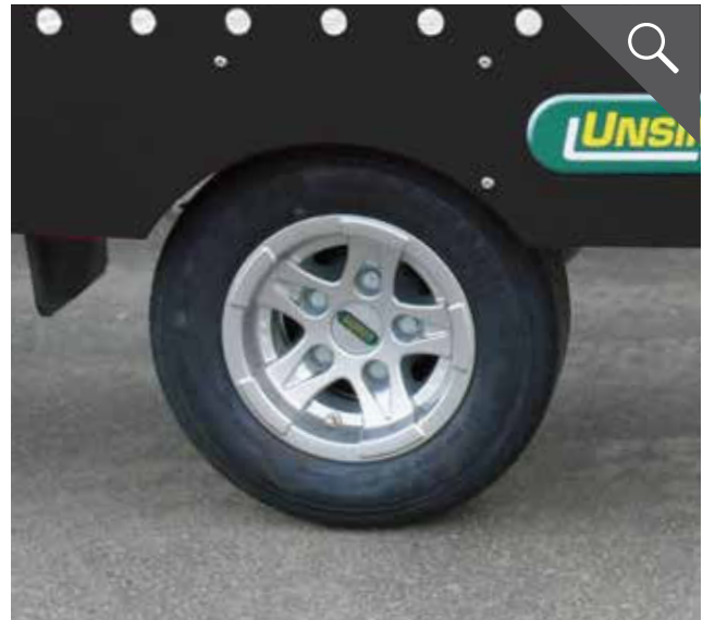
10 Zoll Bereifung für eine niedrige Ladehöhe
