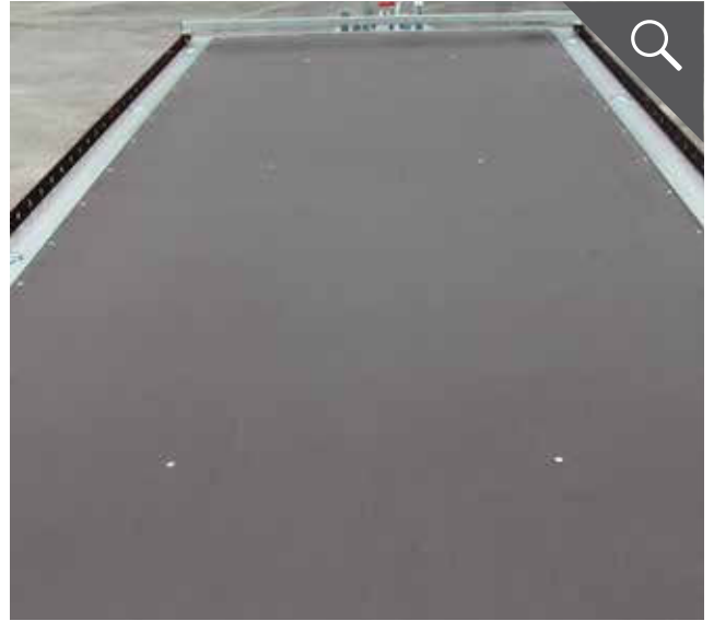
Durchgehende Bodenplatte ohne Stoß (18 mm)
