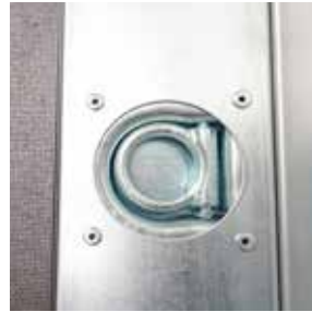
8 Zurrmulden versenkt im Bodenrahmenprofil, Dekra zertifiziert
