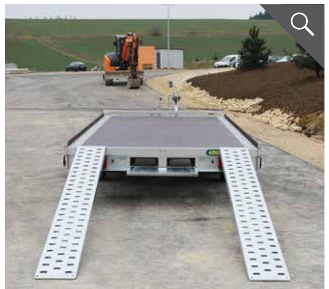
Auffahrtschienen mit 2400 - 2725 kg/ Paar Tragkraft (je nach Modell)
