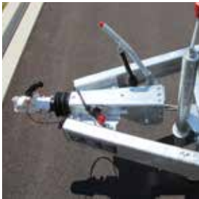
Rahmen aus geschweißtem Hohlprofil
