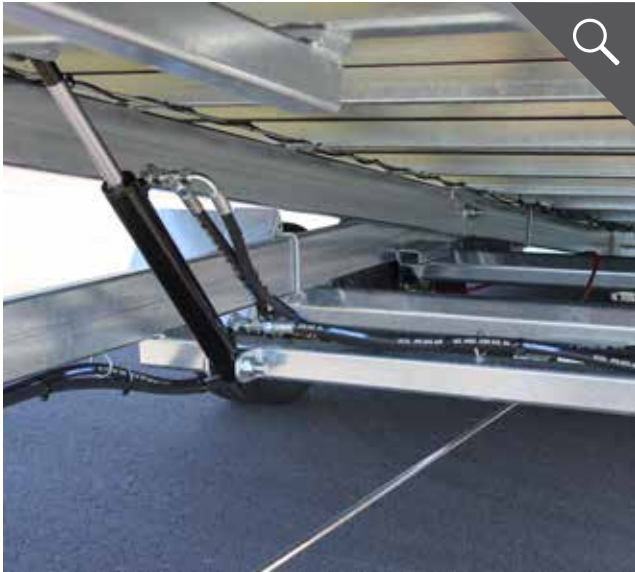
Doppeltwirkende Hydraulikzylinder für sicheres Beladen
