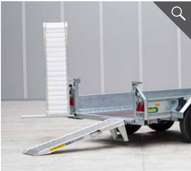
Auffahrrampen komplett wegschwenkbar, ideal für die Beladung mit einem Gabelstapler
