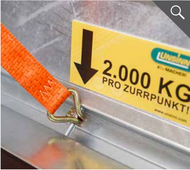
Zurripunkt fest im Rahmen mit 2000 kg Zugkraft
