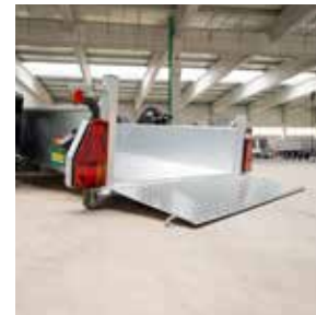
Flacher Auffahrwinkel mit 5°
