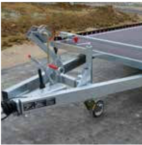
Rahmen aus geschweißtem Hohlrahmenprofil
