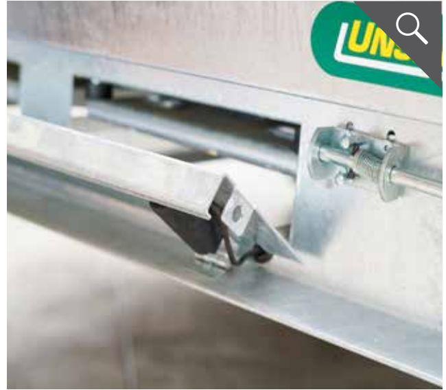
Abklappbarer Kennzeichenhalter zum eleganten Verstauen der Auffahrschienen
