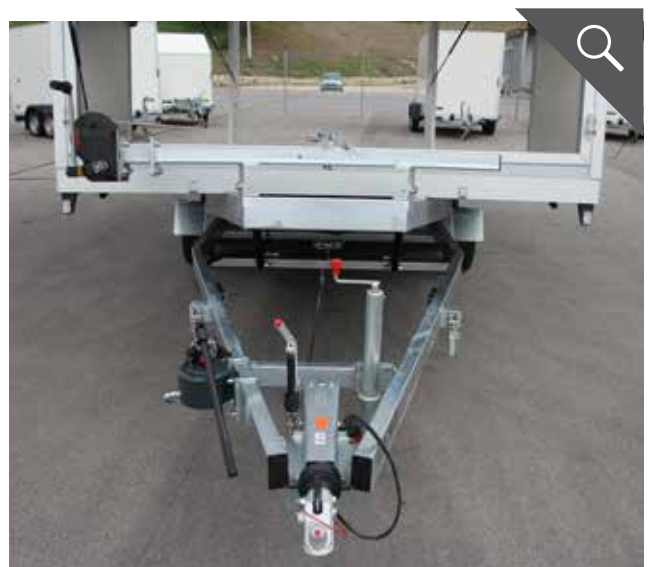
Fahrgestell aus verschweißter und feuerverzinkter Hohlprofilkonstruktion
