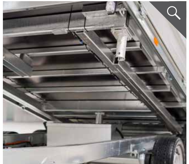
Verschweißter und feuerverzinkter Stahlrahmen
