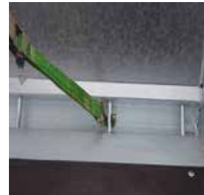
Zurrpunkte bis zu 2.000 kg belastbar
