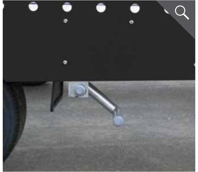
Quickstop-Fußbetätigung zum Entriegeln der Auffahrschienen
