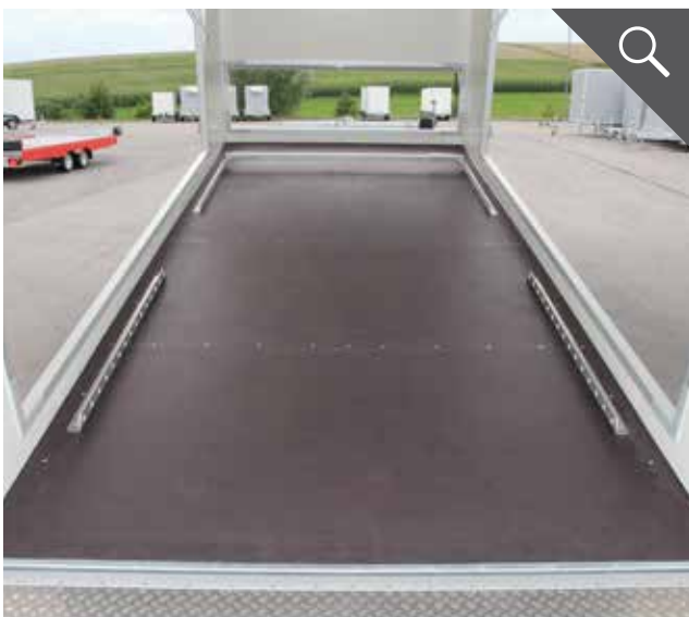
Integriertes Zurrsystem für eine einfache Ladungssicherung
