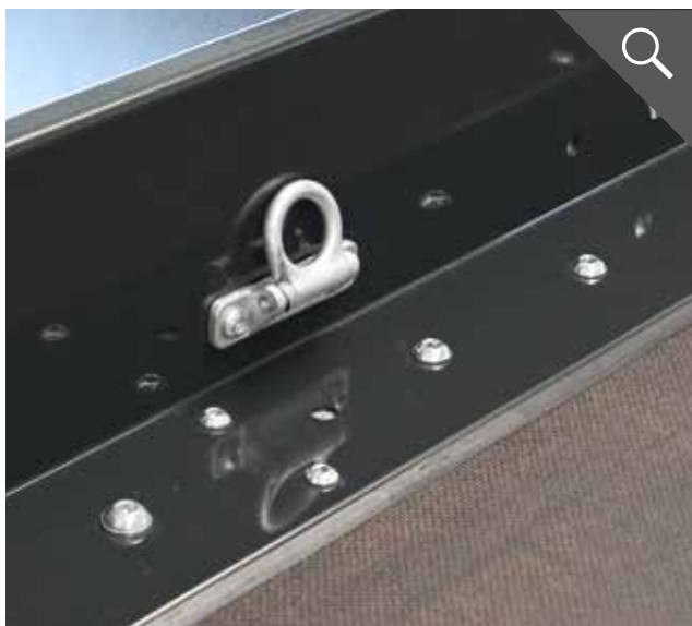
8-10 abklappbare Zurrösen mit bis zu 400 daN Zugkraft
