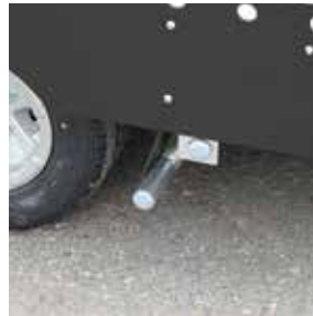
Einfache Entriegelung der Auffahrschienen durch Quickstop-Fußbetätigung
