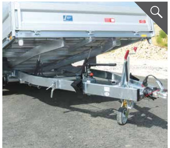
Verschweißter und feuerverzinkter Stahlrahmen
