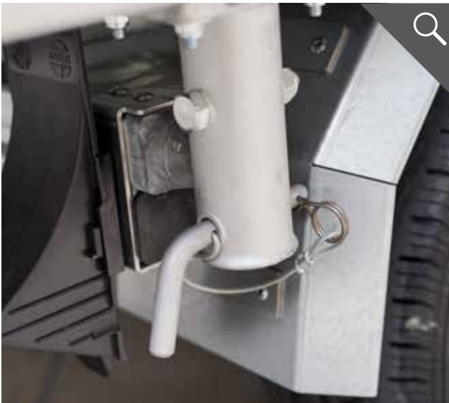
Umsteckbolzen für die Kippfunktion
