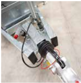
Rahmen aus geschweißtem Hohlprofil für Stabilität
