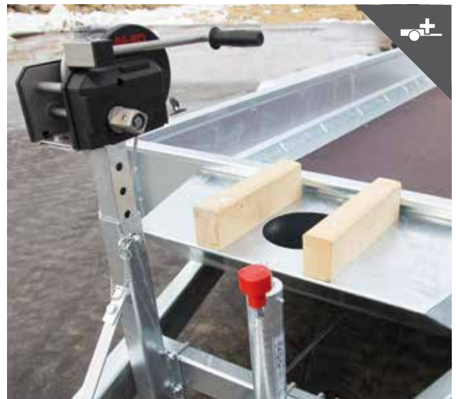
Baggerarmauflage, Windenbock mit Handseilwinde
