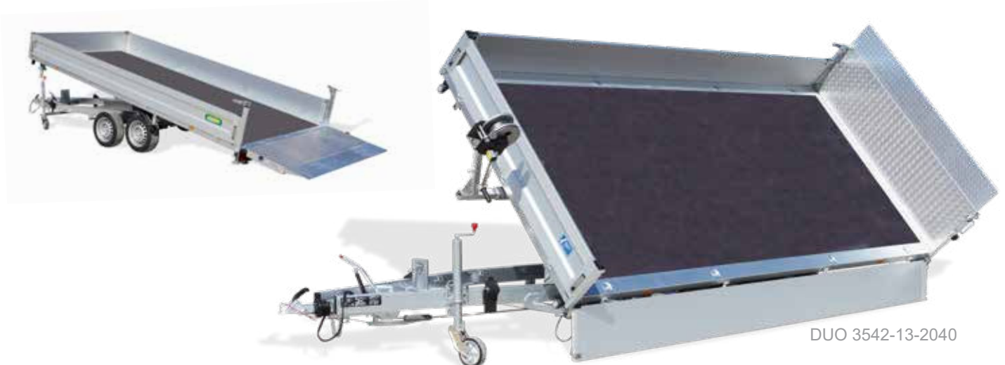
Durchgehende Stahlgitterauffahrklappe mit Alu-Riffelblech belegt
