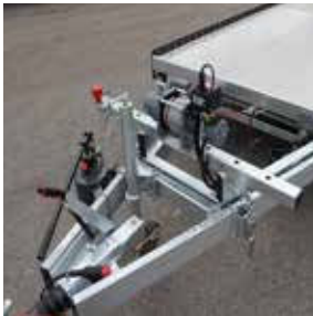
Verschweißter und feuerverzinkter Stahlrahmen
