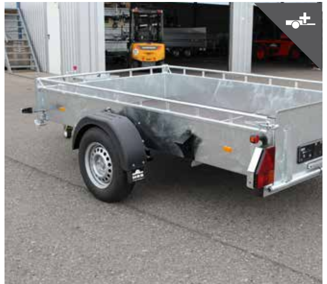
Reling 3-seitig auf Bordwand geschweißt
