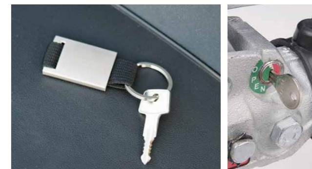
Eén sleutel voor alle sloten dankzij een universele sleutel in drievoud voor de zadelkamerdeur, de instapdeur en de gietijzeren koppeling.
