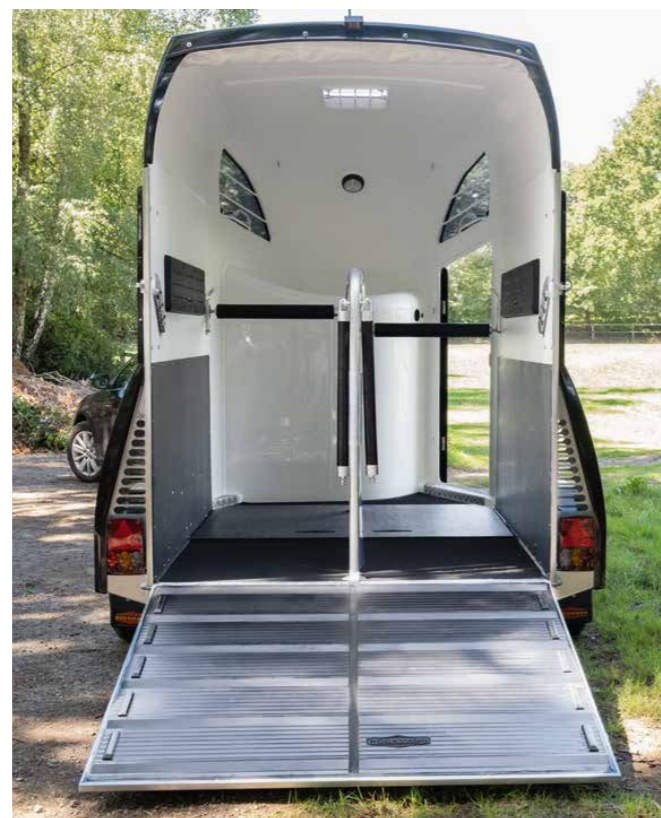
Veel plaats bij het in- en uitladen door een grote afstand tussen boxstangen en zadelkamer in het voorste trailergedeelte.
