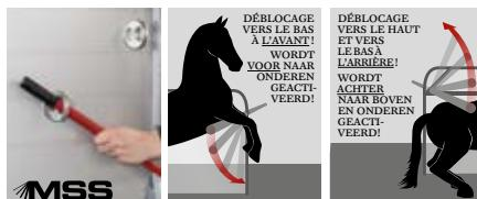
Système « MSS » (Multi Safe System\*\*\*) à barres de sécurité réglables en hauteur et en longueur (système anti-panique) à l'avant et à l'arrière
