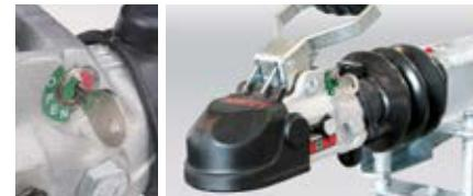
Sécurité de l'attelage et du dételage grâce à un attelage verrouillable en fonte doté d'une poignée confortable gainée et d'un Soft Top (protection anti-collision, Duo Esprit C avec attelage standard non verrouillable)
