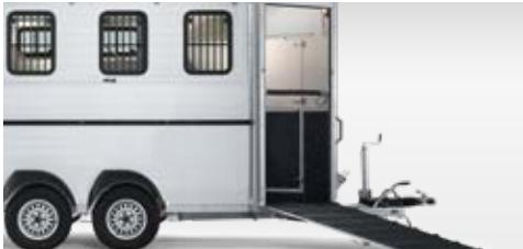
Débarquement aisé grâce à un pont large et particulièrement long revêtu de caoutchouc avec mécanisme de levage (Traveller G uniquement)
