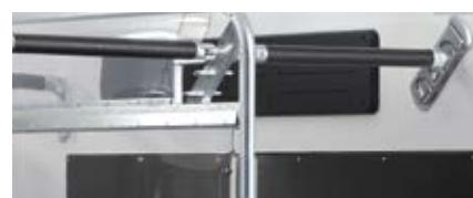
Confort et durabilité grâce au capitonnage latéral et au pare-bottes (en matière composite) sur les deux parois latérales
