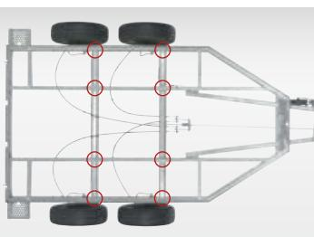
Conçu pour des charges élevées au moyen d'essieux fixés par 8 vis à la construction à longerons et d'un cadre en acier galvanisé à chaud
