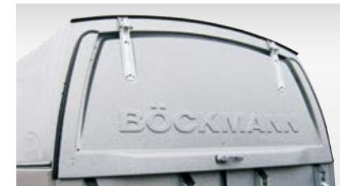
Hayon arrière verrouillable en polyester équipé d'amortisseurs (sauf sur Uno, Duo Pony, Duo Isy, Portax et Traveller)
