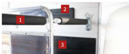
Confort et durabilité : rembourrage supplémentaire des barres de sécurité (1), capitonnage latéral (2) et pare-bottes en matière composite (3)
