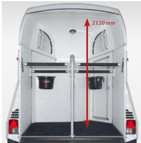
Idéal pour les chevaux de petite taille en raison de sa hauteur intérieure de 2120 mm; deux mangeoires assurent une bonne accessibilité au fourrage pendant le transport
