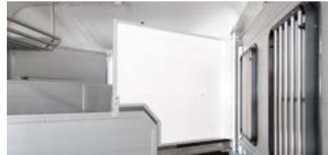
Transport sécurisé grâce à la séparation de tête, pour le transport de deux étalons par ex.
