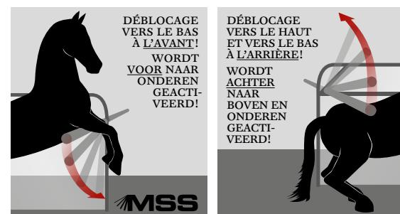
Système «MSS» (Multi Safe System\*\*) à barres de sécurité réglables en hauteur et en longueur à l'avant et à l'arrière (sauf modèle Duo Esprit C) / Het in de hoogte en lengte verstelbare veiligheids-boxstangen-systeem (anti-paniekstelsel) Multi Safe System\*\* voor vóór en achter (behalve Duo Esprit C)
