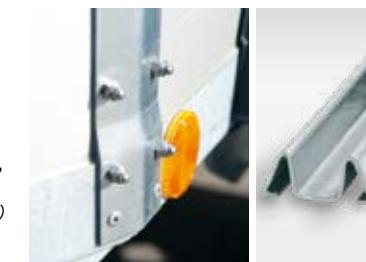
Excellent stabilité grâce aux cornières d'angle et aux renforts latéraux en acier galvanisé en profilés M massifs en acier galvanisé
