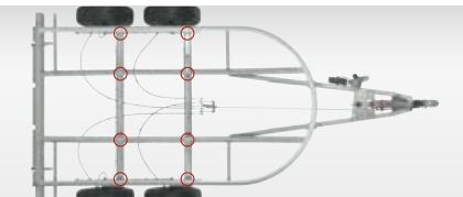
Conçu pour des charges élevées au moyen d'essieux fixés par 8 vis à la construction à longerons et d'un cadre en acier galvanisé à chaud
