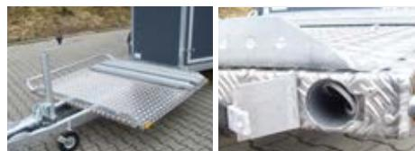
Support d'attelage\* avec tôle en alu striée et rampes de chargement; en option avec tube permettant de ranger le fouet
