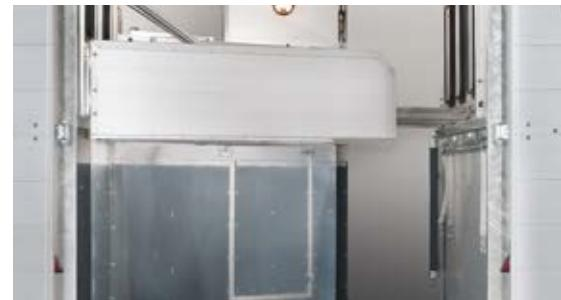
Position optimale grâce au système d'embarquement en diagonale avec bat-flancs en aluminium réglables latéralement et équipés de bavettes en PVC
