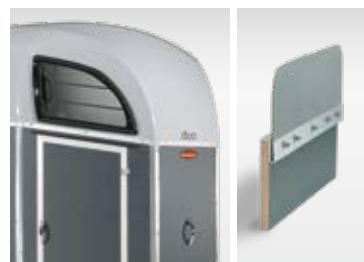
Toit polyester avec grande rigidité grâce au profil en S en aluminium boulonné avec vis acier inoxydable V2A
