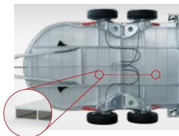
Résistant et imputrescible grâce à son plancher en aluminium massif de qualité (en option\* sur certains modèles); renforcement assuré par un profilé fermé sous le plancher
