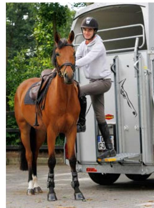
Montoir breveté, facilement rabattable, monté sur le pont arrière (sauf sur Traveller)
