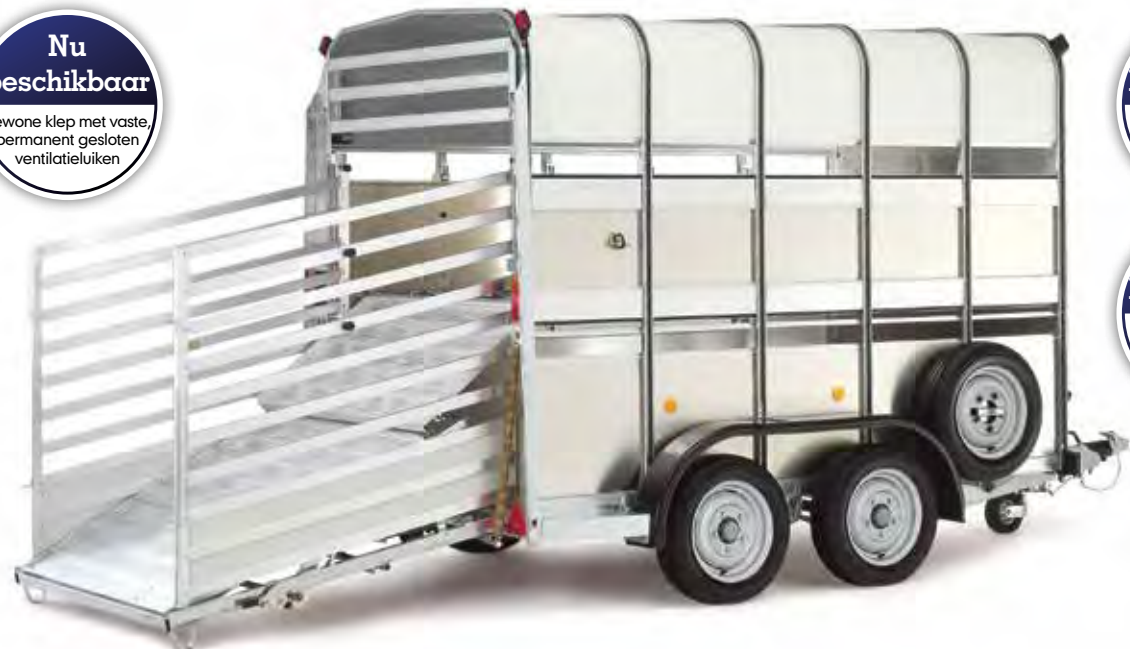
TA510 3.01m x 1.78m x 2.13m en optionele rail voor ventilatieluikjes onder
