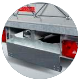
Standaard voorzien van geïntegreerde rijplaathouders
