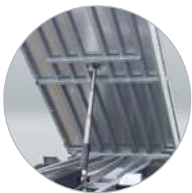
Robuuste vloerondersteuning door kokerprofielen
