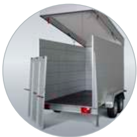
De aluminium laadklep is eenvoudig te (de)monteren
