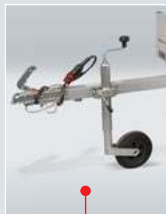
Doorlopende dissel voor optimale vloerondersteuning
