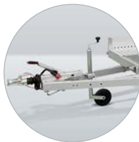
Lange dissel uit stalen kokerprofielen
