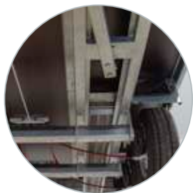
Sterk chassis met geïntegreerde rijplaathouders
