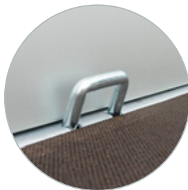
8 bindhaken aan binnenzijde laadbak
